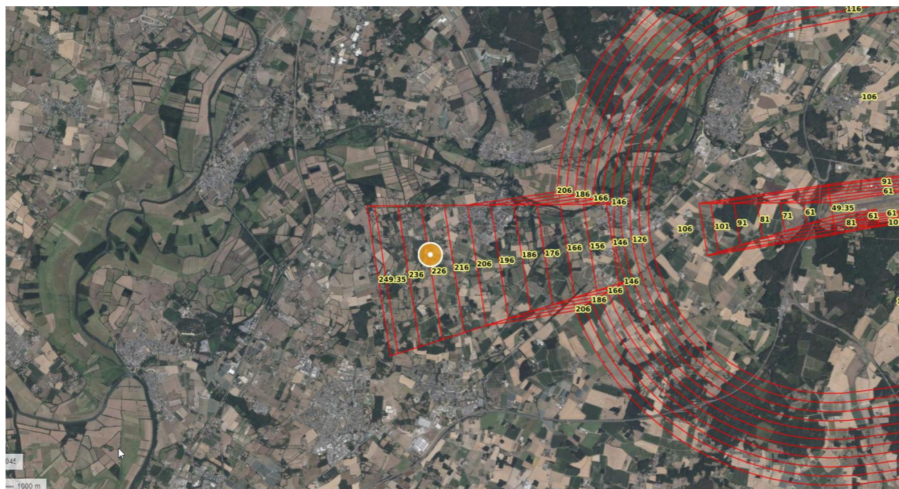
Figure 22: servitude aéronautique aéroport d'Angers Loire
